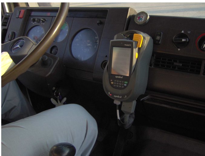
Σχήμα 4.16 Τηλεματική μονάδα οχήματος
